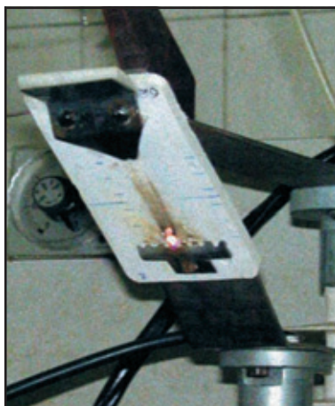
Испытание образца силиконовой резины по ГОСТ 27474.
