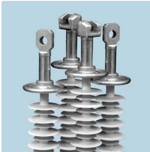
Линейные подвесные стержневые полимерные изоляторы типа **LS 70/20** предназначены для изоляции и крепления проводов и грозозащитных тросов воздушных линий электропередачи и ошиновки распределительных устройств электростанций и подстанций переменного тока напряжением до 20 кВ.
